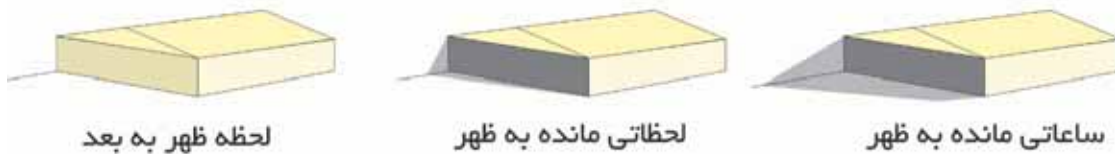
شکل ۴. سنگ شاخص مسجد امام (ره) اصفهان؛ استفاده از آفتاب در تعیین زمان ظهر شرعی
